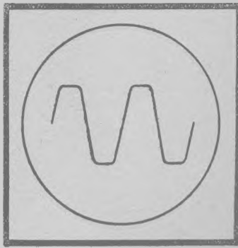
Fig. F-49. — L'amplificateur est saturé.
